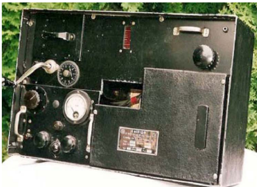
Ламповий електрокардіограф, який використовував проф. В. Ліпінський
